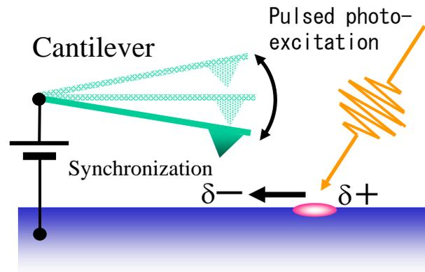
図1: 探針同期時間分解静電気力顕微鏡の原理。
